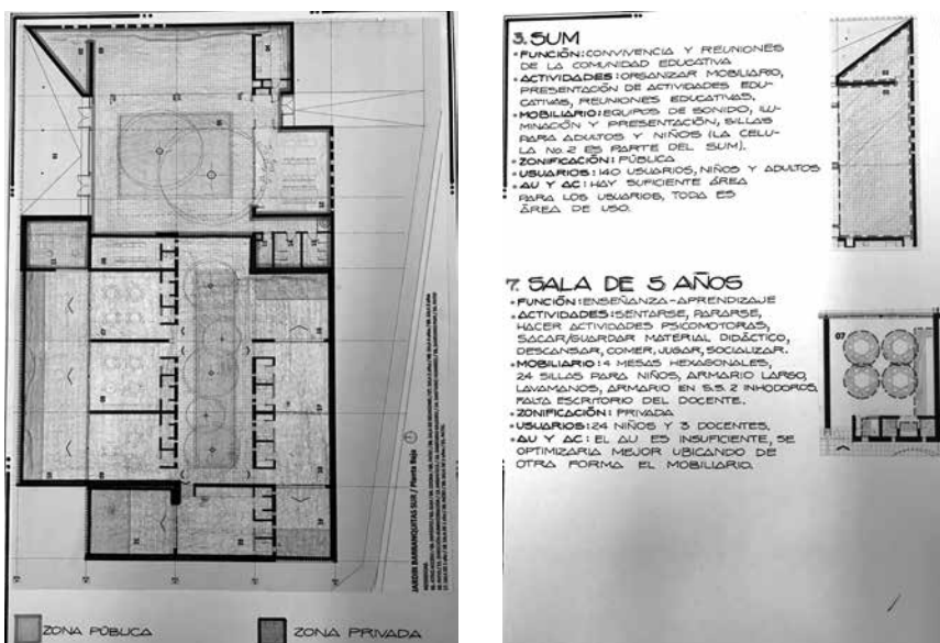
Figura 1. Síntesis del análisis de “casos análogos” de Diseño Arquitectónico 1, que lo hacen con el apoyo de dibujos de plantas arquitectónicas a escala donde primero analizan zonificación, la función, actividades, mobiliario, usuarios, áreas de uso y áreas de circulación de cada una de las células del sistema espacial. Karen Rossicela Morales Ortega, carné 201803865. El trabajo fue presentado el segundo semestre del 2018.
