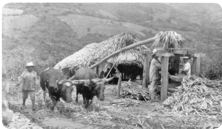
Trapiche de bueyes. En la actualidad Ocublá (Jocotán) es una de las comunidades donde se elaboran distintos productos de caña de azúcar (Cortesía: Jorge Nufio)
