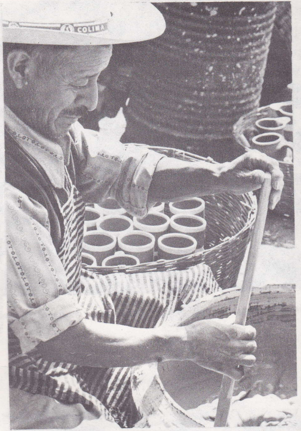
Artesano de Totonicapán preparando los óxidos para el vidriado de la cerámica. Totonicapán. (Fotografía: Mauro Calanchina)
