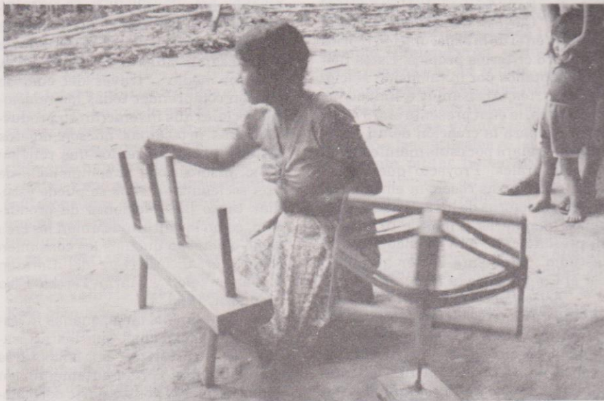
La tejedora prepara los hilos en el "urdidor" y en la "araña", antes de colocarlos en el "telar de palitos". Fotografía de Manuel Guerra.
