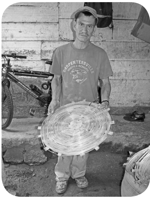
Filtro de canasto para el destilado de la lejía.
