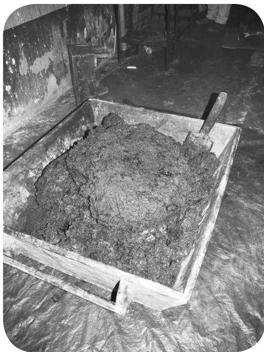
Artesa con jabón caliente, previo a bolearlo.
