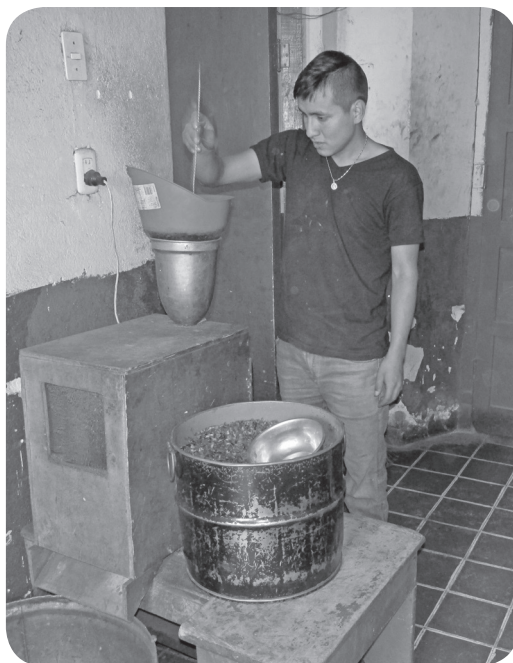
Figura 13 Cribado del cacao empleando maquinaria, producción mixqueña (Esquivel).
