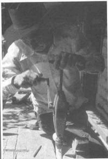
**Foto 11.** La chirimía se afianza en una abrazadera al banco y se perforan los agujeros de digitación con un taladro de 5 milímetros.
