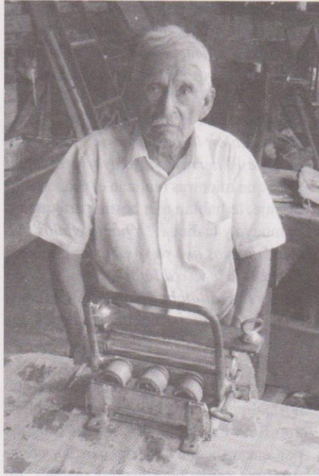
Máquina de hierro, elaborada por don Nolberto en su taller y que usa para desbastar cueros.
