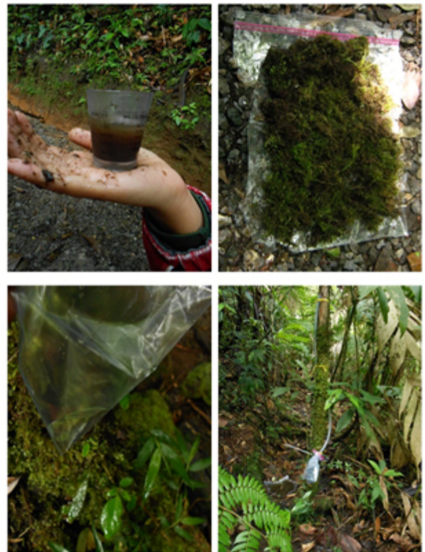
Figura 1. Metodología. Se observan ambos tratamientos para la captación de lluvia horizontal. En la parte superior se observa el método con briofitas, mientras que en la parte inferior el método por escurrimiento del tronco. Fuente: datos experimentales tomados durante la fase de campo.
